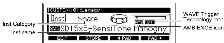
Utilisez le cadran pour modifier l'instrument assigné au pad.
